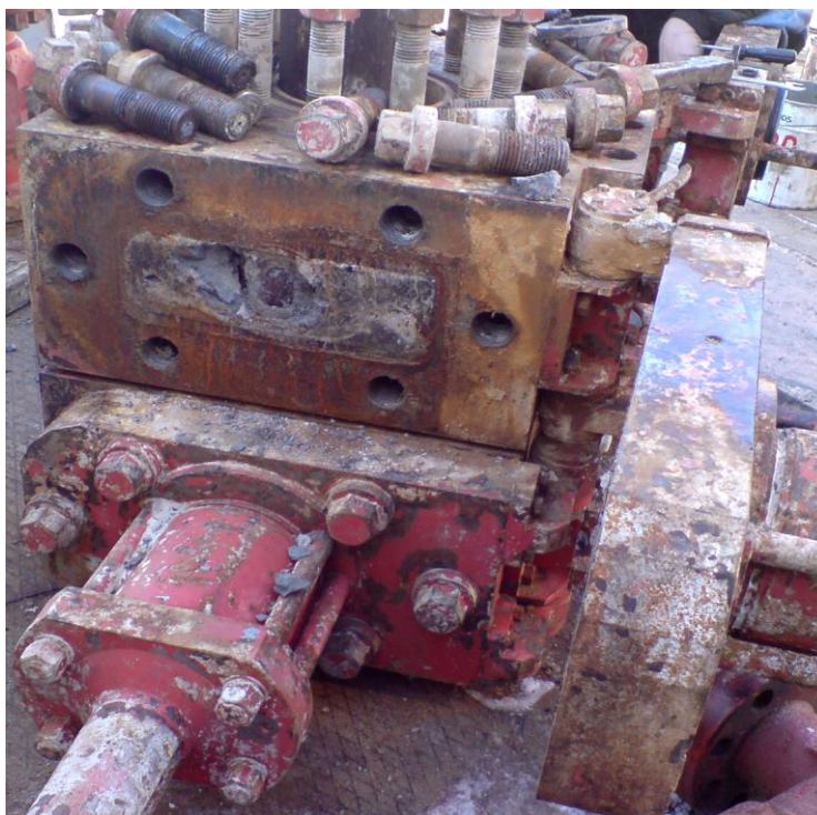
3.1 Сурет -ППГ-180х35 превенторының корпусына плашканы цементтік ерітіндімен бұғаттау
