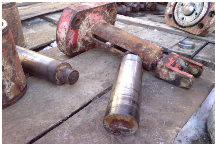
3.2 Сурет - ППГ-180×35 превентор гидроцилиндрінің сынған штогы
